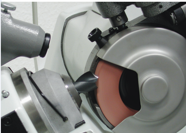
Ausspitzen der Querschneide
