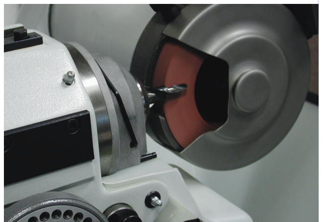
Hinterschliff an Stufenwerkzeugen
